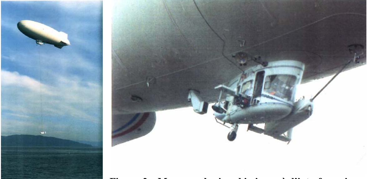
Figure 2 : Mesures physico-chimiques à l'interface air-mer à l'aide d'une plate-forme météorologique suspendue sous la nacelle d'un dirigeable souple gonflé à l'hélium (US-LTA model 138S ) (Photographies fournies par W. Plant).
